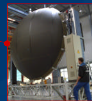
Rear pressure bulkhead, Stade
